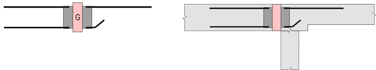
Q: Aufnahme von negativem Biegemoment und Querkraft, Bügeltiefe (BT) nach Mass
